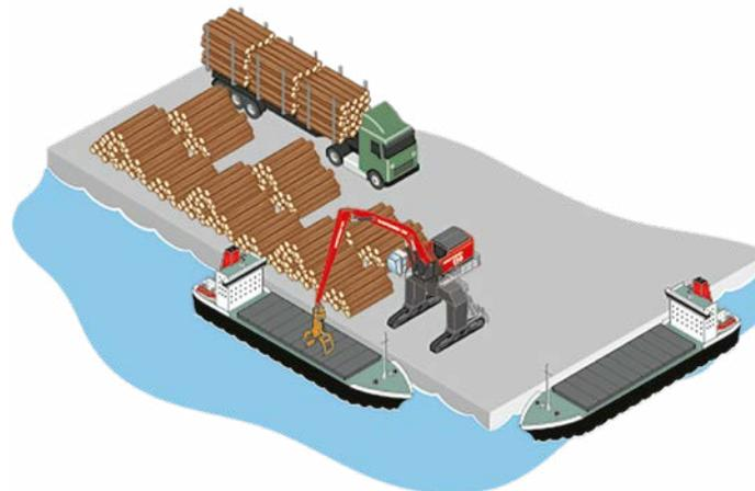
Eine breite Palette an Anbaugeräten, Ausleger- und Stielkonfigurationen sowie Kabinenerhöhungsoptionen machen einen flexiblen Einsatz der Maschine für den Umschlag jeglicher Hafencargos innerhalb der zulässigen Tragfähigkeit möglich.
